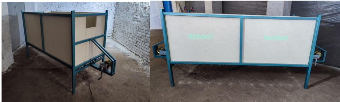
Рис. 3.6. Загальний вигляд вермиреактора безперервної дії з ручним приводом
