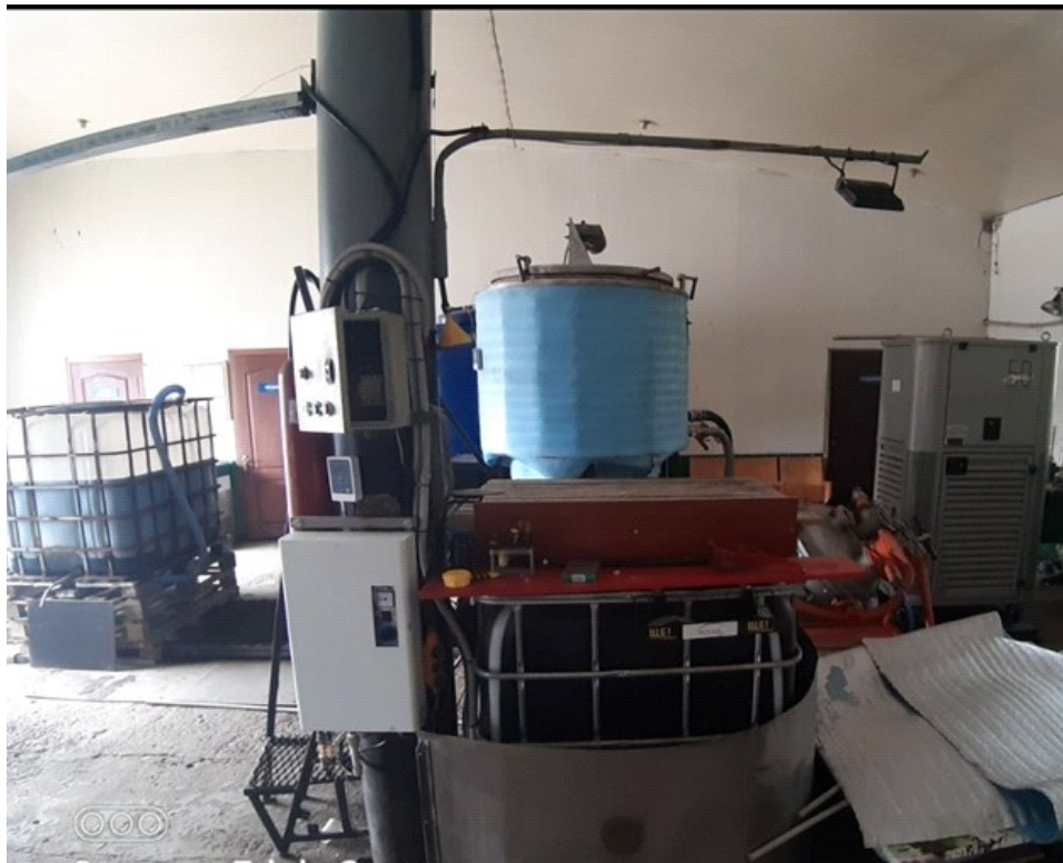
Рис. 3.14. Додаткове обладнанням апарату вихрового шару АВС-100
