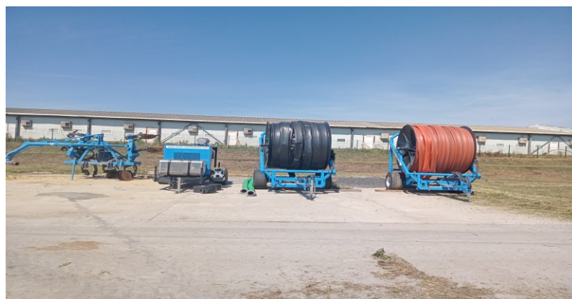
Рис. 3.29. Обладнання для внесення рідкого гною на поля: зліва направо: 1 - інжекторний культиватор для внесення гною А ТОМ 7 DS, 2 - насосно-дизельна станція, 3, 4 - причіпні транспортувальники шлангів для гною А ТОМ - 2000
